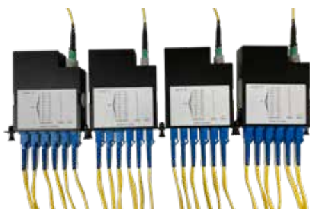
Aktuelle kassettenbasierte Architektur
